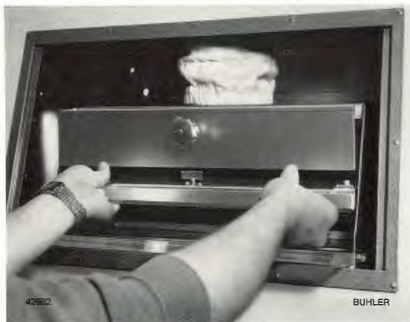
Speisung; leichter Ausbau der Einlaufklappe, zum Beispiel zwecks Reinigung.
