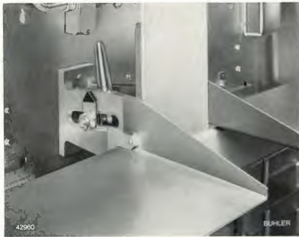
Auslaufdisposition (oberer Teil): In der Mitte des Bildes die hintere Aufhängung des Abräders. Wurfwinkel von 5° bis 15° verstellbar. Gute Zugänglichkeit. Metall-Türen mit Magnet-Anhaftung. Der Abräder ist an drei Punkten in Torsibloc-Gummilagern aufgehängt.
